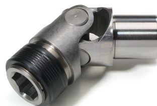
WELLEGELENK DIN 808 MIT NADELLAGERUNG W ZAPFEN, SCHNELLWECHSELKUPPLUNG
